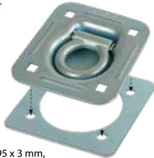
Platte 102 x 95 x 3 mm, Bohrung M6, Ösengröße 44 x 8 mm, Bruchkraft 1600 kg, zulässige Zugkraft max. 800 kg
