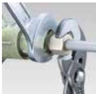
Schraubzange als zweiter »Schlüssel« bei Konterverschraubungen
