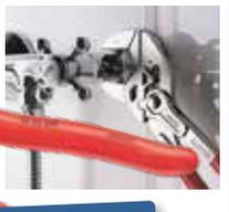
Zange und Schraubenschlüssel in einem Werkzeug
